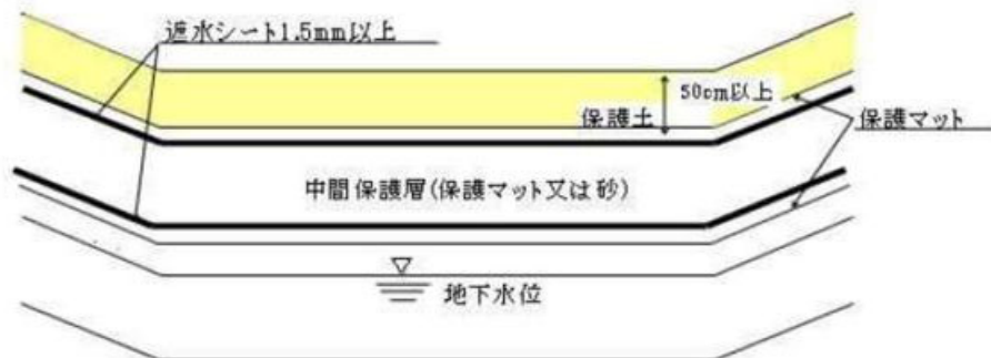
図 3.2-3 表面遮水工（処分場底部）の構造
