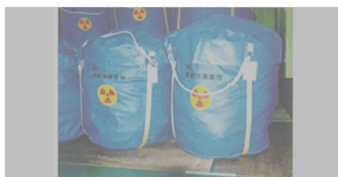
フレキシブルコンテナ（ポリエステル製）に収納したコンクリート廃棄物
